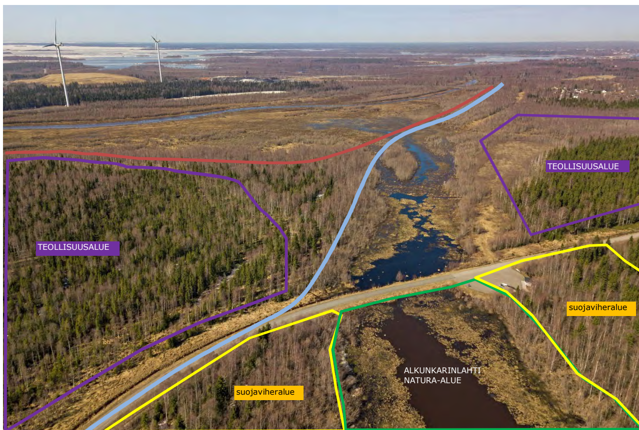
Kuva 24. Hahmotelma kaavassa esitettyjen tie- ja ratalinjausten, teollisuustoimien alueiden ja suojaviheralueiden sijoittumisesta Koi-vuodon alueelle.
